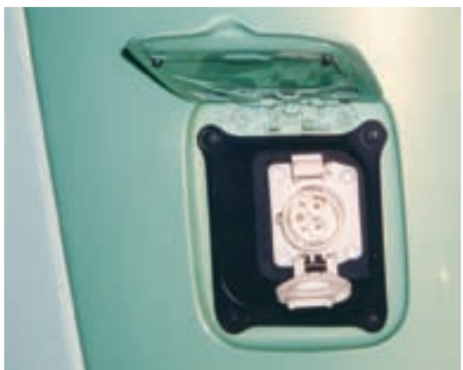
Japan ligger långt framme i utvecklingen av elhybridbilar. Denna Toyota Prius visades upp 1999 i Tokyo. Detaljbilden visar kontakt på japansk plug-in bil för laddning från elnätet.
